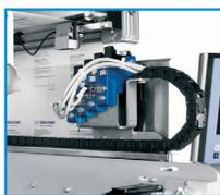
Le teste di stampa "Blue" delle stampanti Videojet/Wolke montate sulla bobina di una macchina termoformatrice. Le teste si spostano da destra a sinistra, codificando più imballaggi in un unico passaggio.
